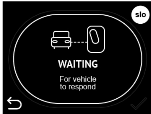
Figura 16: A estação de carregamento aguarda que o VE responda e comece a carregar
